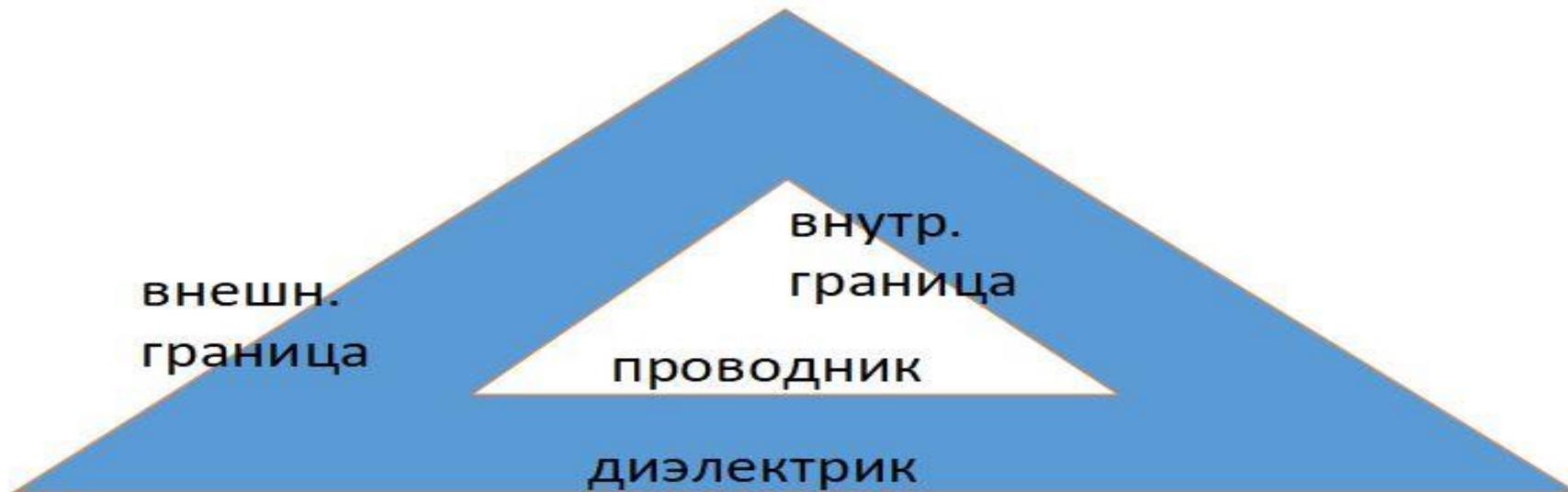
На внешней границе поступаем, как в случае круглого кабеля. На больших расстояниях от проводника раскладываем потенциалы в ряд по  $r$  и используем асимптотику по первому члену разложения:
