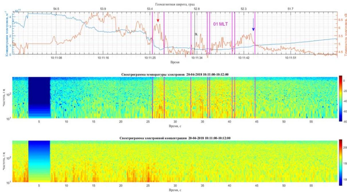
Изменение концентрации и температуры электронов при пролете в 10 UT и их спектрограммы. Красная стрелка — поляризационный джет; вертикальные зеленые линии — приблизительные границы поляризационного джета; вертикальная черная линия — момент времени, когда спутник пересекал L-оболочку 3; синяя стрелка — предполагаемая экваториальная граница субаврорального потока конвекции на запад (SAPS).
