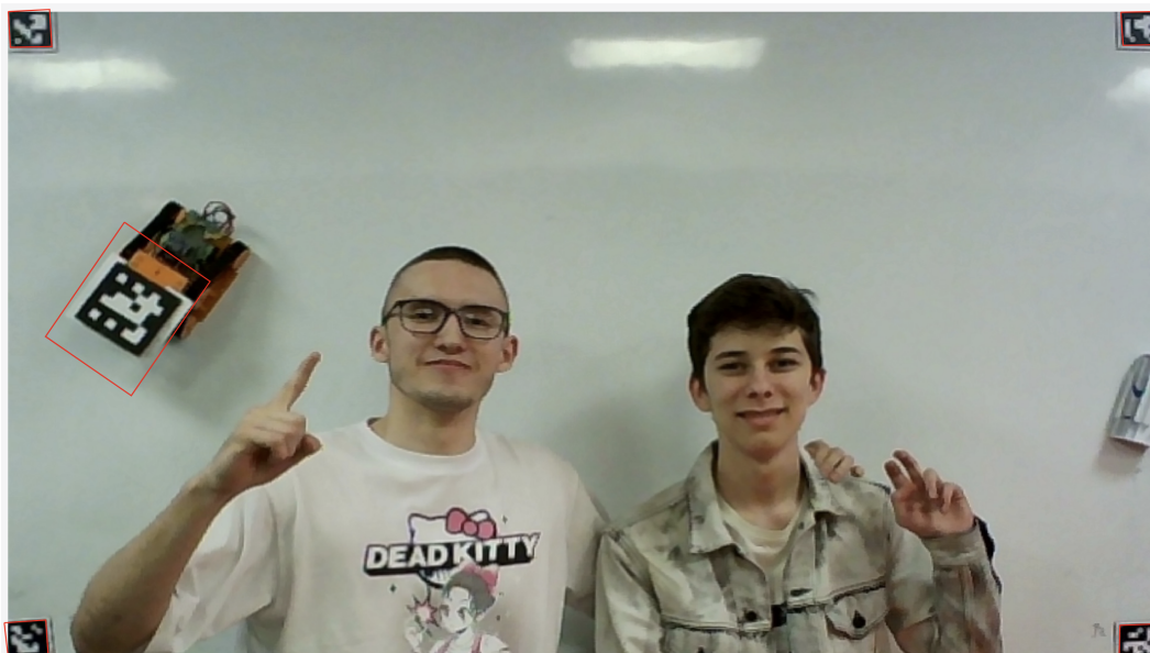
Рис. 5.2: Изображение доски после репроекции. Также определенные на доске Агисо маркеры выделены красной границей
