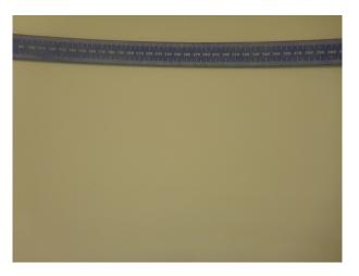
Рис.: Фотография физически прямой линейки откалиброванной в воздухе камерой, сделанная под водой.
